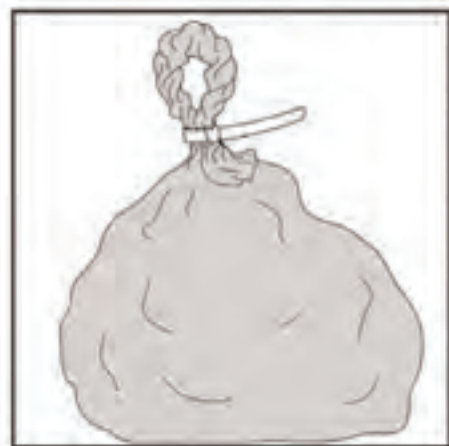
將封口膠帶拉緊形成有效的密封
