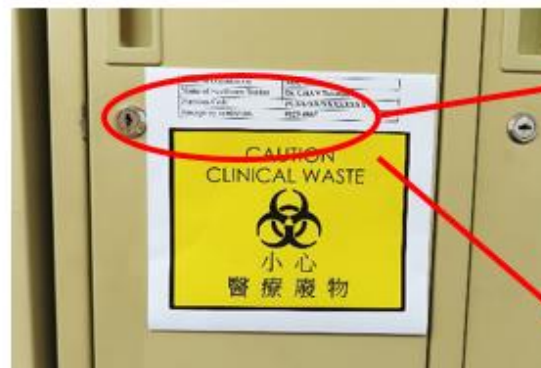
圖例三：醫療廢物貯存櫃上的標籤及警告標示示例
